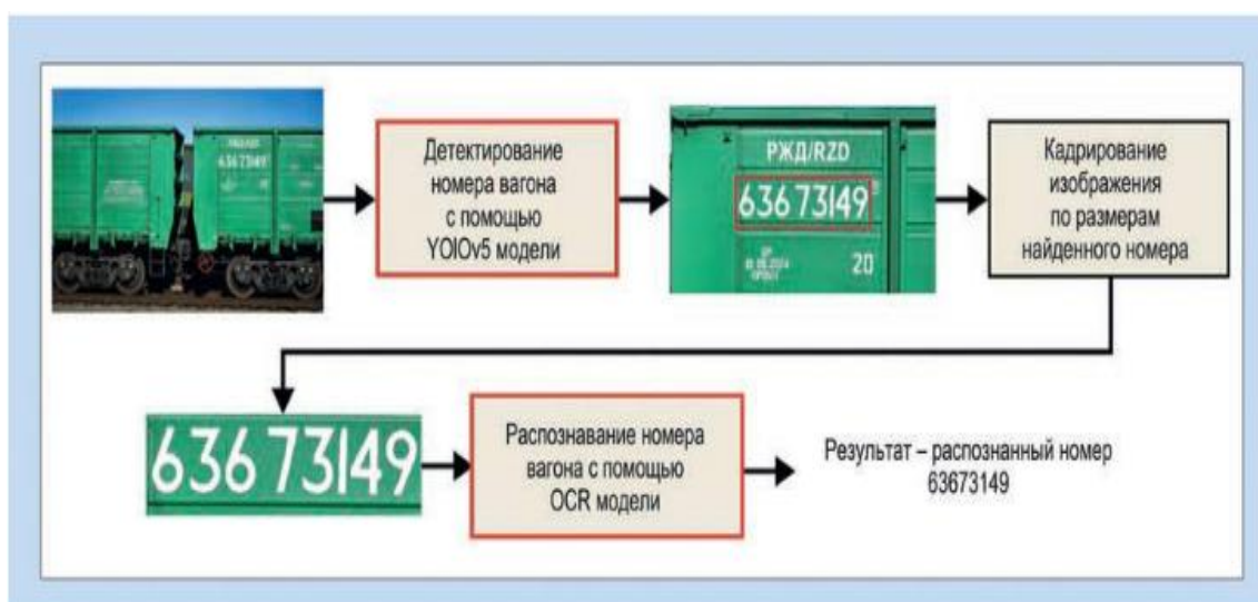
Схема алгоритма распознавания номера вагона
