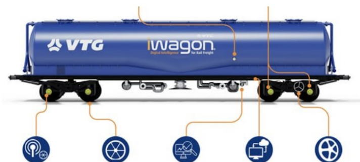
Рис. 1. Схема новой системы мониторинга грузовых вагонов в режиме реального времени iWagon
