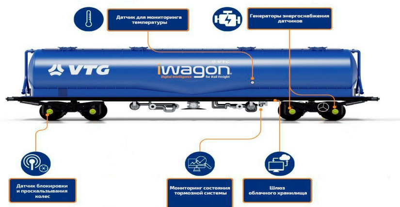
Рис.2. Схема расположения датчиков iWagon на цистерне
