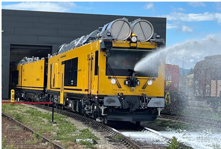
Рис. 3. Система распыления воды Servicejet
