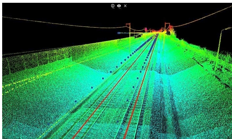
Рис. 2. Трехмерная модель пути, созданная мультисенсорной платформой «360° MSP»
