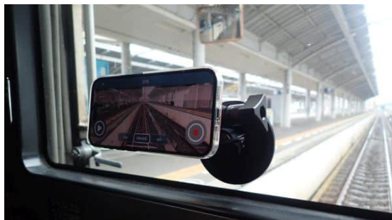
Рис. 1. Пример установки смартфона, оснащенного приложением для инспекции пути
