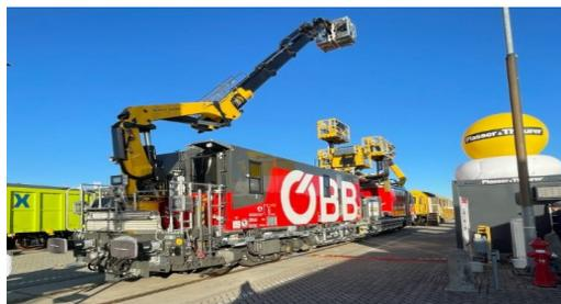
*Рис. 3. Путьевая машина CatenaryCrafter 15.4 E3*
