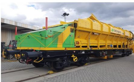
Рис. 1. Самоходный хоппер-дозатор DHS Hybrid от SRT
