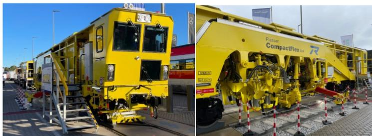
*Рис. 2. Стабилизатор пути CompactFlex 4×4*
