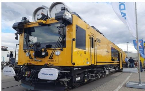
*Рис. 7. Пожарно-спасательный поезд Servicejet от Stadler*
