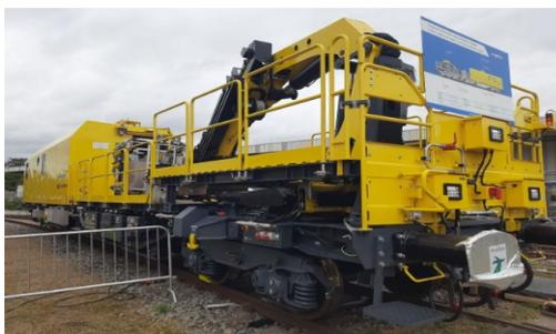
*Рис. 4. Состав XTmas для обслуживания контактной сети от Harsco Rail*
