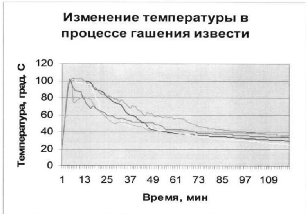
Фиг.2 - График. Изменение температуры реакционной массы в разных вариантах гашения извести
