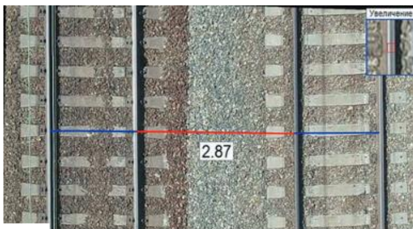
Фрагмент измерения междупутья БПЛА в режиме реального времени
