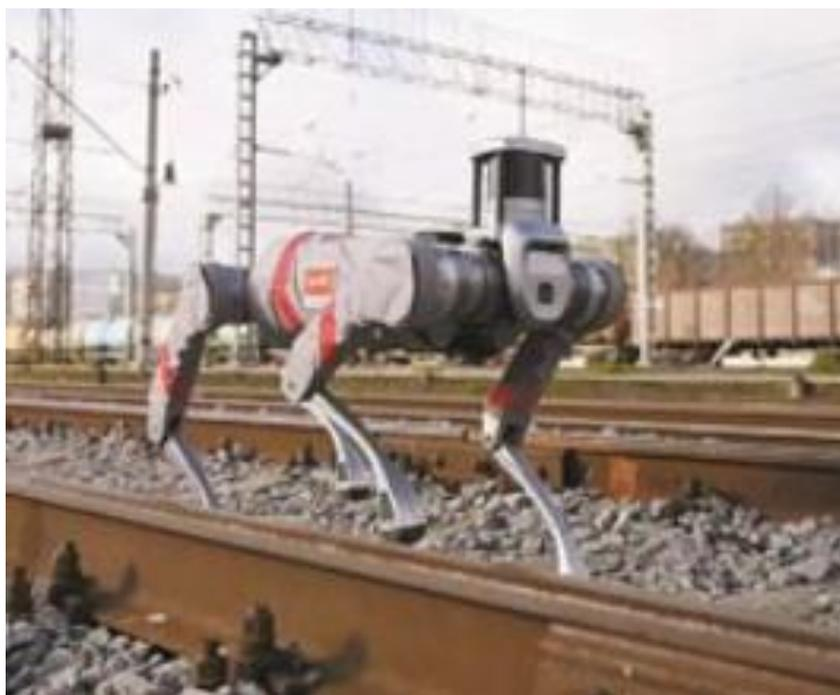
В ходе разработки роботизированного приёмщика вагонов будут исследованы и протестированы различные методы и инструменты, такие как лазерные сканеры, тензOMETрические датчики, камеры глубины, которые позволят роботу полностью выполнять функции по допуску грузовых вагонов на инфраструктуру ОАО «РЖД».
