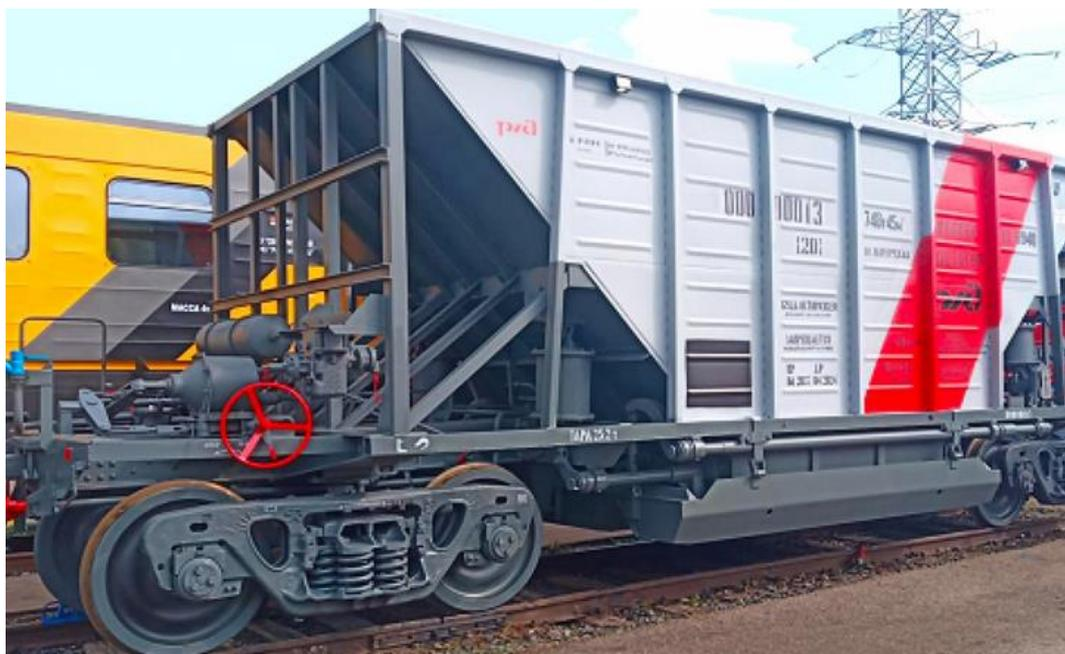
Отличия модели 19-6940 от ВПМ-770 следующие: увеличенная до 25 т осевая нагрузка и, как следствие, возросшая на 5 т грузоподъемность;
