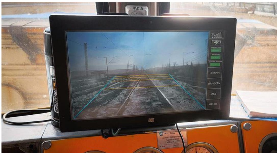
Система успешно прошла испытания на уклонах крутизной 40‰ и в кривых радиусом до 50 м. Емкости встроенного в МБВ аккумулятора хватает на работу в течение не менее 12 ч даже при температуре до – 40 °С. Для установки сменного аккумулятора не требуются дополнительные инструменты.
