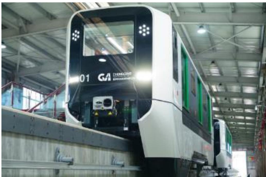
Поезда в зависимости от пассажиропотока будут эксплуатироваться в составах по 1–4 вагона. Каждый сможет вмещать по 112 человек. Подвижной состав оборудован синхронными двигателями на постоянных магнитах. По сравнению традиционным трехфазным асинхронным двигателем вес такой силовой установки ниже на 30 %, а энергоэффективность выше на 10 %.
