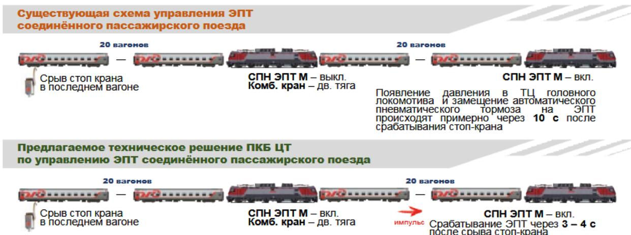
В текущем году для подтверждения эффективности предложенных технических решений, направленных на снятие ограничений по продольной динамике и обеспечение быстрого и эффективного реагирования тормозных средств соединенного пассажирского поезда в экстренных ситуациях, запланировано проведение широко-масштабных экспериментальных исследований. Ходовые испытания технологии вождения соединенных пассажирских поездов с применением опытных образцов устройства
