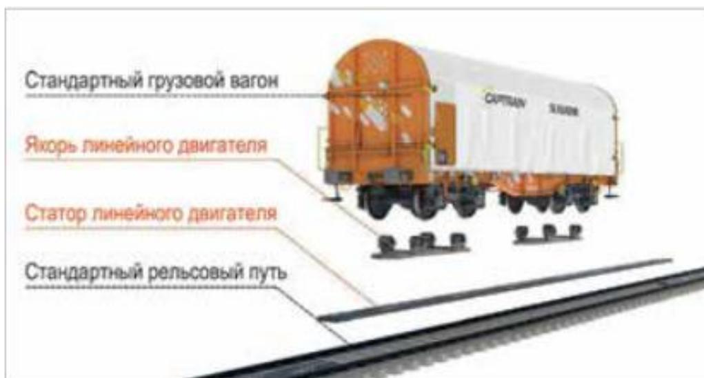
Суть проекта, получившего название BREMAG (Бременский магнитный шаттл), заключается в модернизации уже существующей железнодорожной инфраструктуры по технологии MagRail, разработанной компанией Nevomo. В существующий путь монтируется статор линейного двигателя, а сам двигатель размещается на тележке вагона вместе с магнитами для подвешивания вагона.
