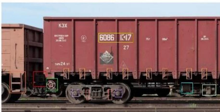
Впоследствии, сравнивая данный перечень с архивным арсеналом и проверяя наличие всех составных частей грузового вагона, которые необходимы для контроля, устанавливают, соответствие этих деталей подвижного состава с зафиксированными кадрами. В случае наличия не соответствующих по своим характеристикам или отсутствующих элементов в вагоне, данные фиксируются общим перечнем дефектности конкретной подвижной единицы.
