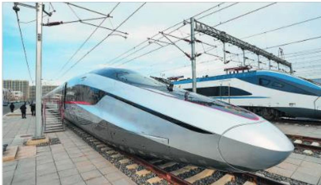
Ожидается, что он будет курсировать по новой линии Чэнду – Чунцин протяженностью 292 км на юго-западе страны. Открыть ее планируется в 2027 г. Масса поезда снижена на 10 %, а сопротивление движению – на 22 % по сравнению с поездами CR400 Fuxing, эксплуатационная скорость которых составляет 350 км/ч. Уровень шума в салоне снижен на два децибела, а пространство для размещения пассажиров увеличено на 4 %.
