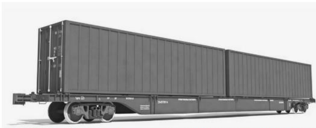
Фитинговая платформа с контейнерами, расположенными дверями наружу
