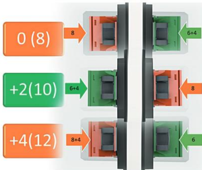
Схемы вариантов регулировки ширины колеи (зеленые боковые упоры имеют вертикальную полку толщиной 6 мм, оранжевые — 8 мм; цифра после знака «+» обозначает толщину металлической вставки)
