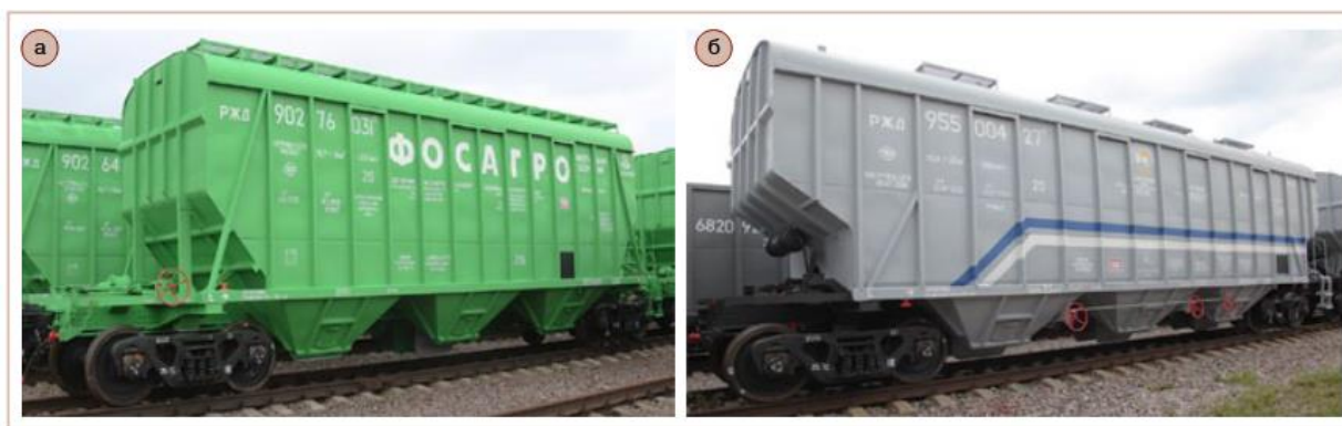
Вагоны-хопперы: а — для минеральных удобрений модели 19-9835-01; б — для зерна модели 19-9549
