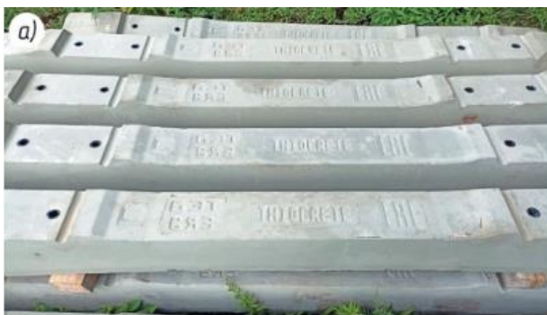
Общий вид шпал из серобетона до монтажа креплений (а) и после установки креплений ЖБР-65ППР (б)
