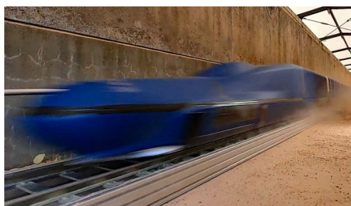
Рис. 3. RTRI использует модель поезда и измельченную скорлупу грецких орехов для исследования налипания снега на тележках
