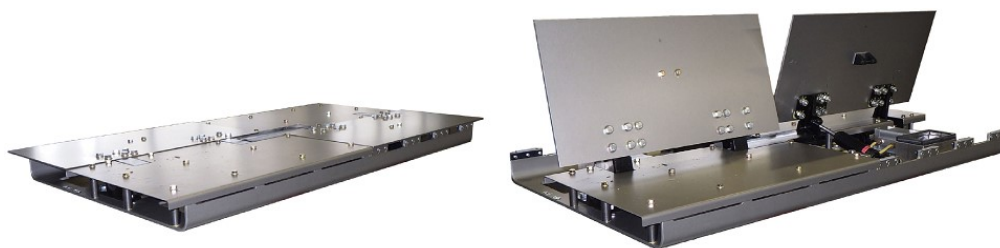
Рис. 1. Аэродинамический тормоз в сложенном (слева) и рабочем состоянии (справа)
