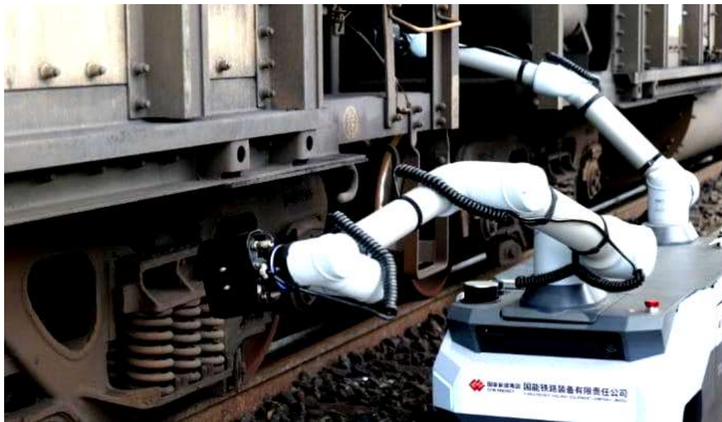
Рис. 1. Интеллектуальный роботизированный комплекс для осмотра грузовых поездов
