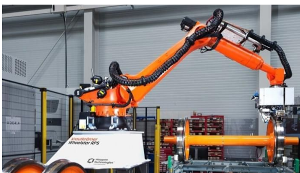
Рис. 1. Система предназначена для обнаружения дефектов на колёсах различной геометрии и в различных условиях
