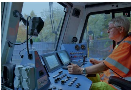
*Рис. 1. Кабина управления путевой машины с дисплеем системы ETCS в Норвегии*
